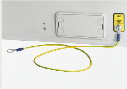
El punto de puesta a tierra está dispuesto en la parte posterior del armario. Un cable de puesta a tierra para la puesta a tierra por el lado del edificio está incluido en el suministro .
