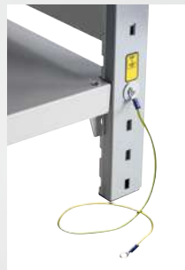
La estantería ESD lleva rieles galvanizados que establecen la derivación al punto de puesta a tierra del sistema de estantería. Con estos rieles galvanizados se ponen en contacto los estantes con recubrimiento ESD.
