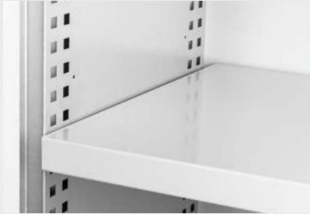
Construcción sistematizada de armario con estantes regulables en altura, con recubrimiento de polvo ESD . En la superficie de apoyo de los estantes tiene lugar un contacto conductor con la pared del armario.
