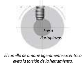
Colocación fácil y rápida durante el proceso de contracción.
