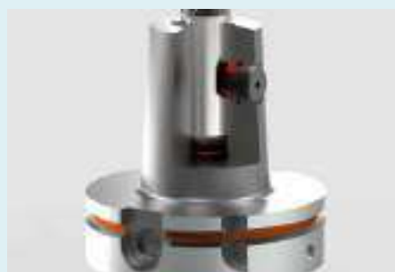
El resorte en el cuerpo de base aprieta la fresa o el mango HB a la posición correcta.
