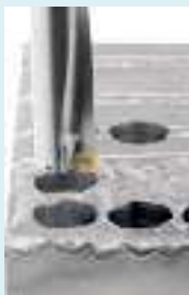
Inicio de taladrado en un cordón de soldadura o superficies onduladas.
