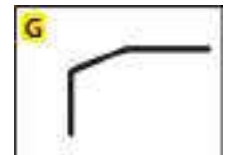
Arista de corte (biselada). Biselado de uso general para acero hasta 67 HRC.
