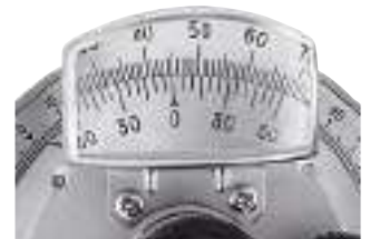
Ajuste exacto y muy sencillo del nonio gracias al ajuste preciso y a la lupa panorámica de ampliación.
