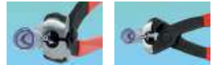
Montaje a presión lateral
