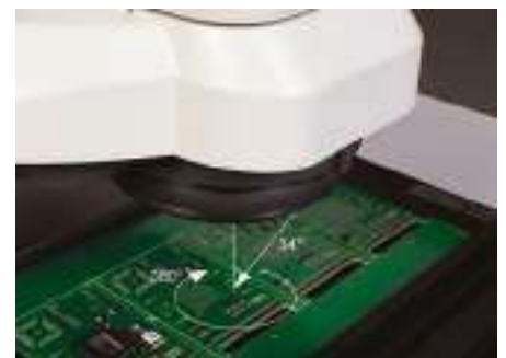
La óptica angular con giro de 360° permite una observación más precisa de los detalles. En un ángulo de 34° también se distinguen perfectamente detalles ocultos en componentes o características verticales.
