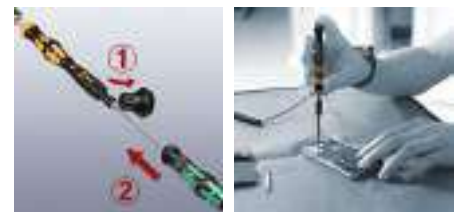
Ajuste mediante destornillador hexagonal SW 1,5.
