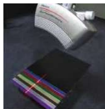
Medición de placa de muestra de color
