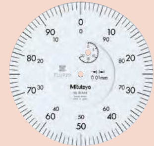
Graduación: 0.01 mm Intervalo de medición: 20 mm
