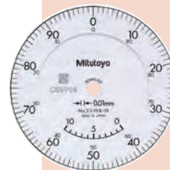
Graduación: 0.01 mm Intervalo de medición: 10 mm
