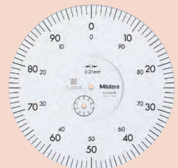
Graduación: 0.01 mm Intervalo de medición: 10 mm
