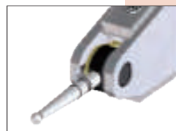
Diseño antiguo: punto de contacto sostenido en el marco.
