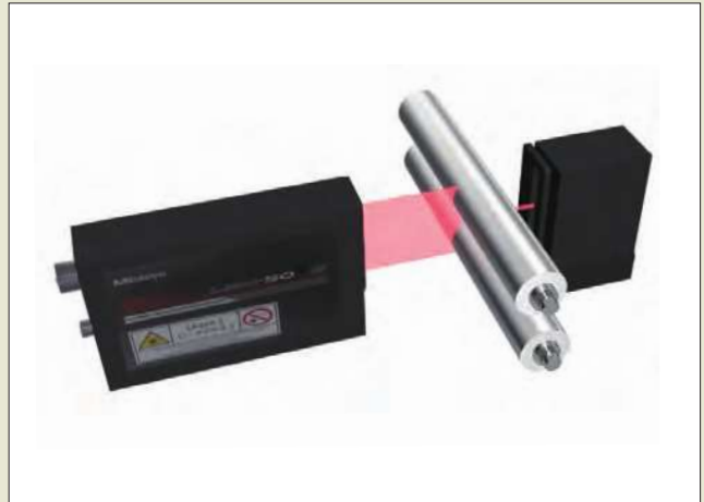
Medición de espacio entre rodillos
