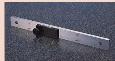
Agujeros para acoplamiento en bloques patrón
