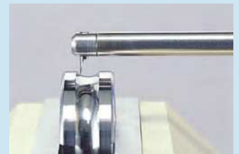
Contorno interior y exterior de un cojinete
