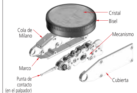
Nuevo diseño: el punto de contacto sostenido en la placa inferior proporciona una acción de seguimiento más suave.
