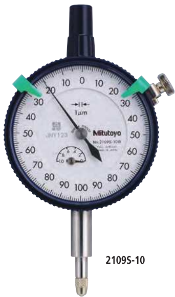
Graduación: 0.001 mm Intervalo de medición: 1 mm
