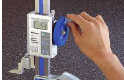
Suave deslizamiento del cursor con manivela
