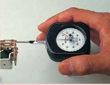
Medición de la fuerza de contacto en un relé.
