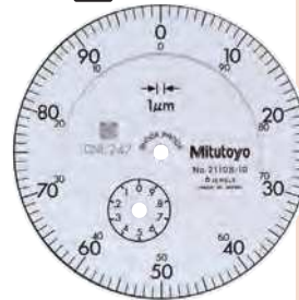
Graduación: 0.001 mm Intervalo de medición: 1 mm
