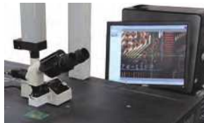
Sistema de monitor de CCTV para CMM (opcional)
