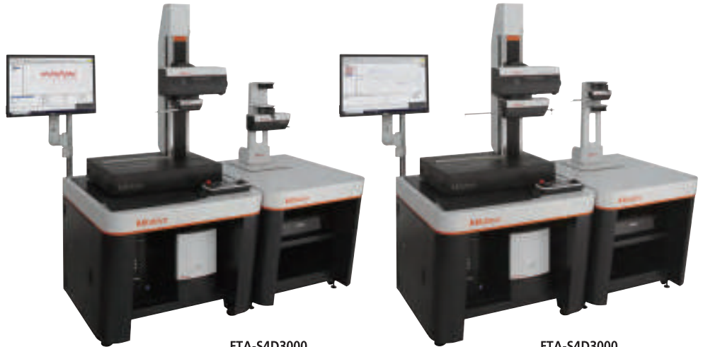
FTA-S4D3000 (Detector para medir la rugosidad superficial con brazo para monitor (opcional))
