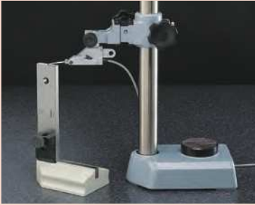
Fijando un indicador de carátula tipo palanca a un apilamiento de bloques patrón sujetos a la base con un conector tipo D
