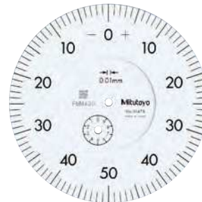
Graduación: 0.01 mm Intervalo de medición: 10 mm
