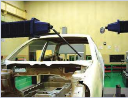
Ejemplo de medición tipo dual (Equipado con palpador de contacto y palpador láser)
