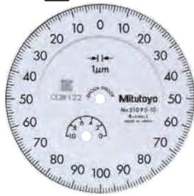
Graduación: 0.001 mm Intervalo de medición: 1 mm
