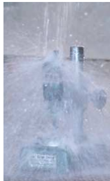
Con clasificación IP66 a prueba de agua y polvo y resistencia al aceite mejorada.
