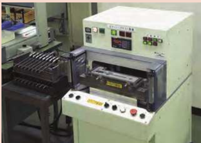
Equipo de prueba de fuga de aire para calibrador a prueba de refrigerante ABS
