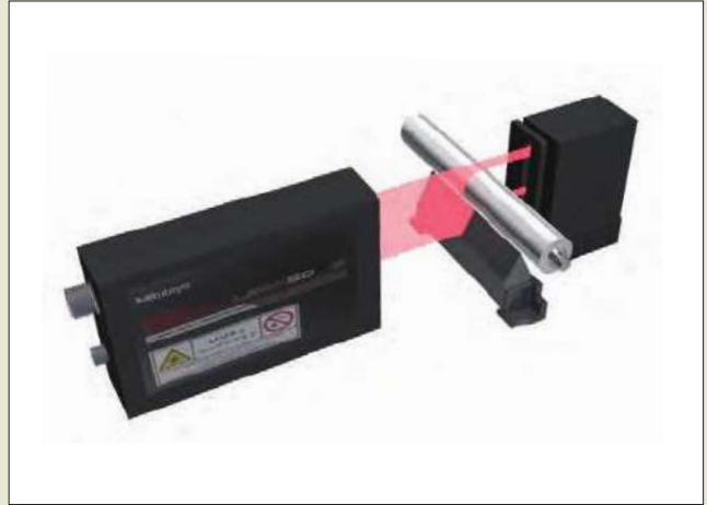
Medición del diámetro exterior y redondez del cilindro
