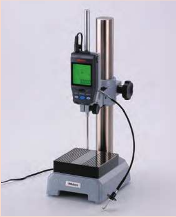
Ejemplo de aplicación usando un indicador Digimatic ID-H
